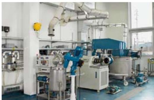
*Centre technique équipé des broyeurs **DYNO®-MILL** dernière génération*
