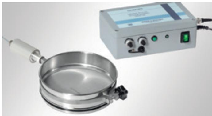
Tamis de contrôle avec anneau de tension, convertisseur et générateur.
