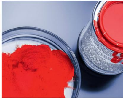
**Revêtements en poudre et films séchés** La cristallinité des plastiques et la masse volumique réelle des pigments secs sont contrôlées par la pycnométrie des gaz pour mieux comprendre le comportement mécanique de ces matériaux. De plus, la pycnométrie des gaz peut aider à déterminer le contenu organique volatil dans les films séchés afin d'évaluer le niveau de réticulation.
