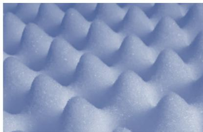
**Polymères et mousses** La pycnométrie des gaz est largement utilisée pour caractériser les quantités relatives des phases cristallines et amorphes dans les matériaux polymères. Cette technique est également utilisée pour évaluer le contenu des cellules ouvertes des matières en mousse pour prévoir leur performance d'isolation thermique ou acoustique ou encore d'amortissement des chocs.
