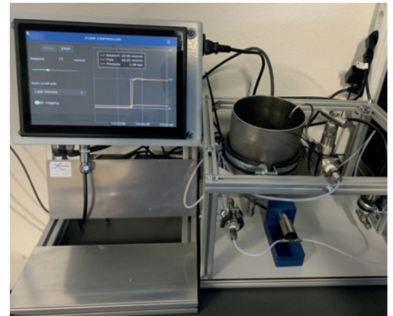
Version industrielle en association avec un système de micro-dosage pour l'ajout d'additifs à faible volume.
