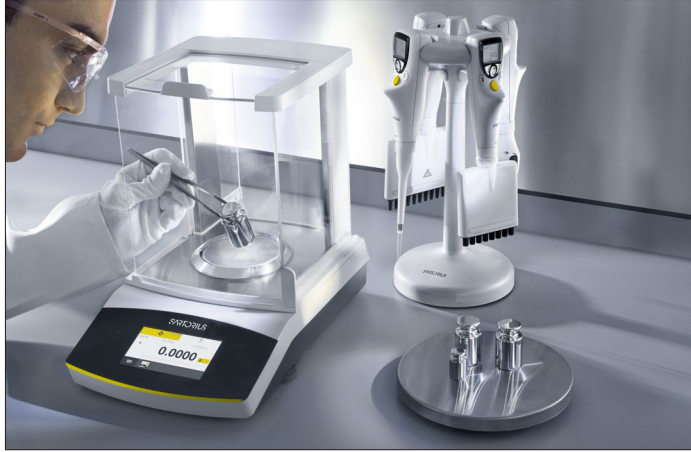
Figure 3 : Vérification de la précision des balances de laboratoire avec des poids de test externes.
