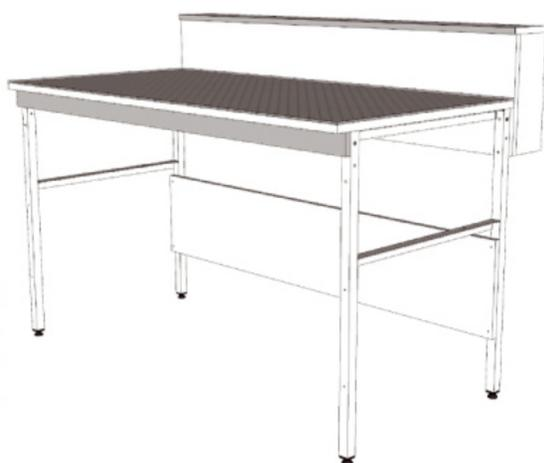
Cette paillasse utilise le même piètement que la paillasse bandeau bois, mais est équipée d'un bandeau avant bois de 60mm au lieu des 140mm habituels, permettant à l'utilisateur de travailler assis devant la paillasse, sans risque de heurts au niveau des jambes, ou de glisser un système de réfrigération ou autres appareils dont la hauteur est inférieure à 810mm.
